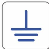
Класс защиты от поражения электрическим током I (заземление через вилку)
