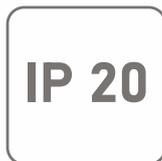
Ращита от внешних твердых предметов диаметром  $\geq 12,5$  мм.
